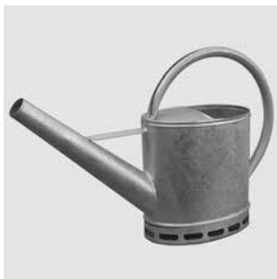
138 Bitumengießkanne mit großer Ausgussöffnung Höhe 305 mm Höhe mit Griff 460 mm Breite 295 mm Breite mit Griff u. Tülle 700 mm Tülle ø 45 mm Inhalt ca. 12 Liter Gewicht 3,50 kg
