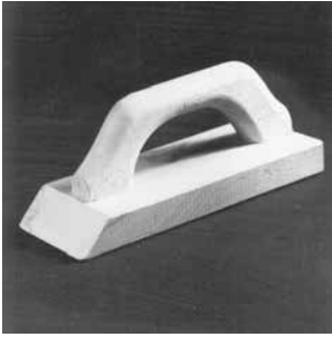
155 Asphalt-Reibebrett (Hartholz) eingeschraubter Griff Reibefläche 250 x 100 x 30 mm Gewicht: 0,50 kg
