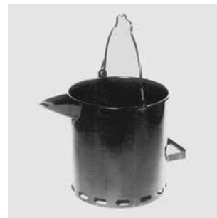
141 Bitumeneimer mit Ausguss, starkem Griff und Bügel, mit Bodenbelüftung, schwarz lackiert Höhe 310 mm ø 300 mm Inhalt ca. 20 Liter Gewicht 3,50 kg
