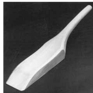
113 Asphaltspachtel (Hartholz) aus einem Stück Reibfläche 330 x 110 mm 55 mm stark mit langem Griff Gewicht: 1,60 kg
